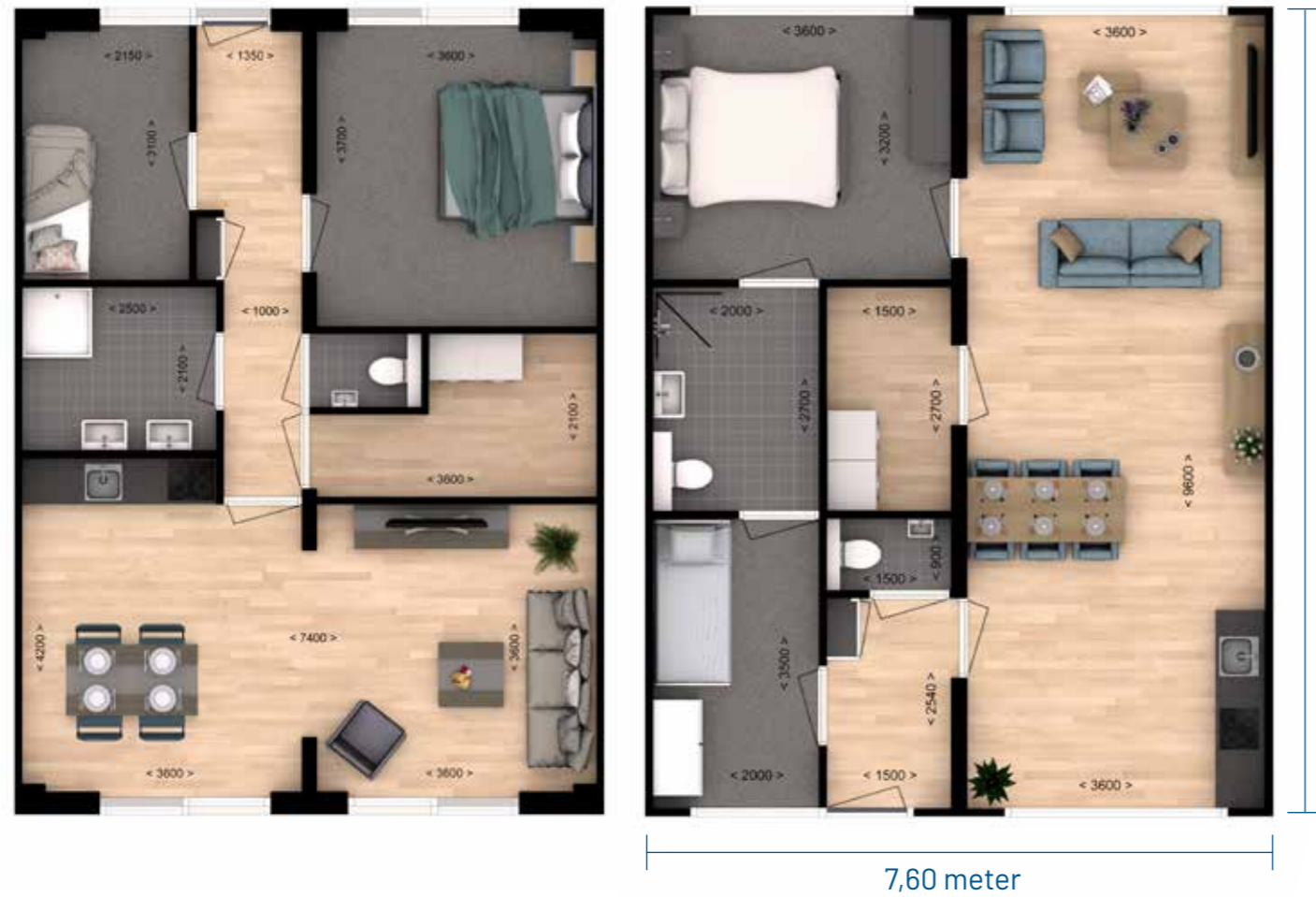
Voorbeeld indelingen gekoppelde elementen in een appartementsgebouw.
